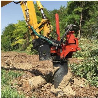
Rotor Hydro 17/25 echipat cu cilindru extractor. Fotografie din documentația producătorului.
