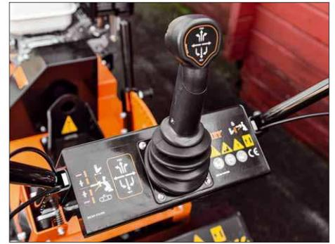
Der Joy-Stick im Fahrstand erlaubt eine präzise Steuerung des Turfaway. Doch bevor es losgeht muss der Griff zur Aufhebung der Totmannschaltung betätigt werden
