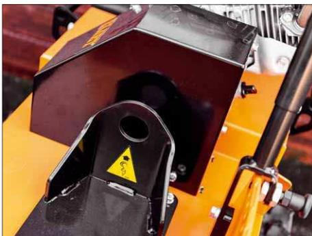
In der Mitte der Maschine befindet sich zur Verladung eine Kranöse
