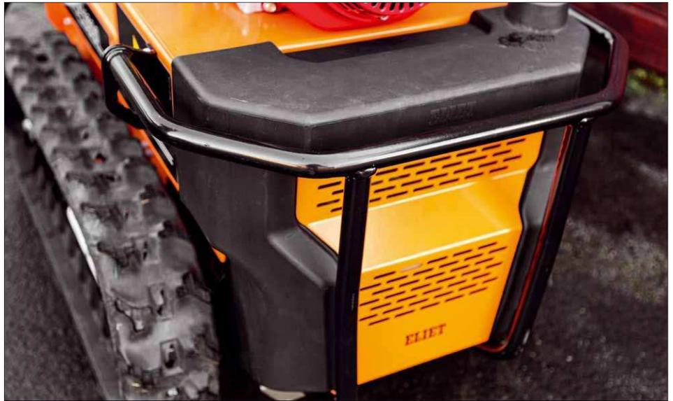
Um die Maschine und ihren Motorblock bei der Arbeit und dem Transport zu schützen, ist vorn ein Stoßfänger angebracht
