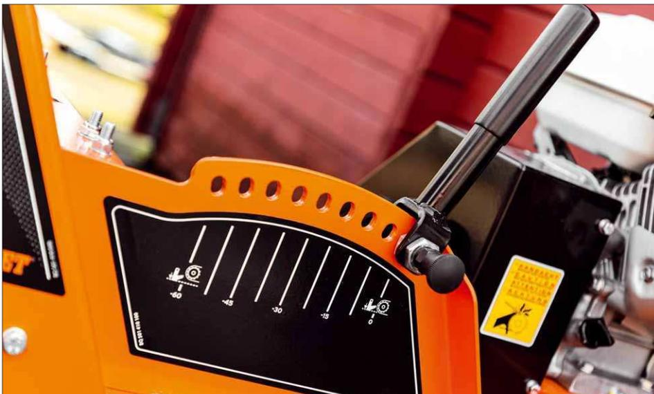
Die Schnitttiefe des Bügelmessers wird mit diesem Hebel eingestellt. Es sind Schnitte bis zu 60 mm Tiefe möglich
