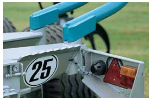
Beleuchtung geschützt im Rahmen integriert
