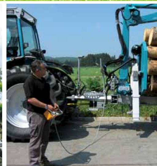
Pfanzelt EHC-Steuerung mit 6 m Steuerkabel in Bauchtragweise
