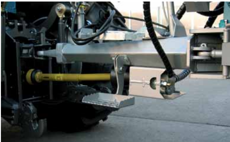
Zahnradpumpe fest verbaut unter der Deichsel
