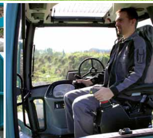
Bedienung des Ladekrans aus der Schlepperkabine mittels Joystick
