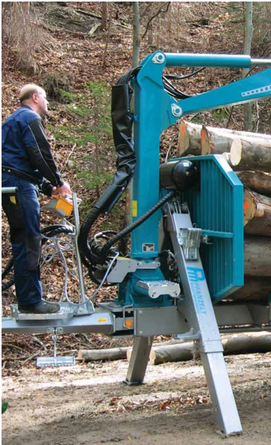
Schwenkbare Deichsel, mechanische Arretierung für Straßenfahrt
