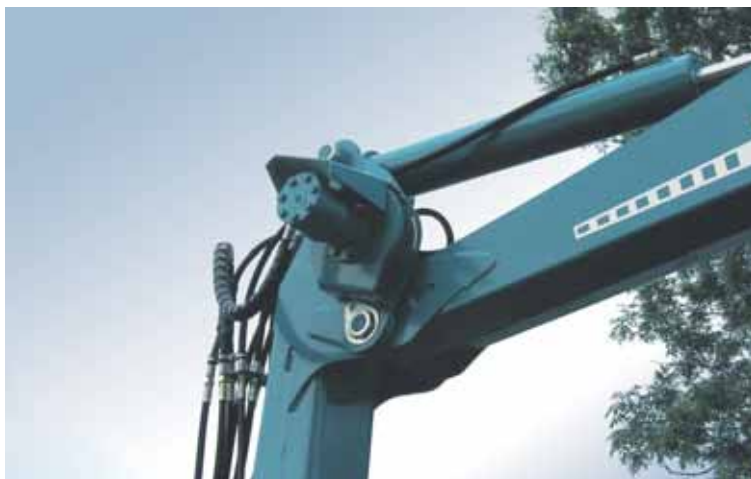
Kranseilwinde mit 1,5to Zugkraft, Bedienung über Funk
