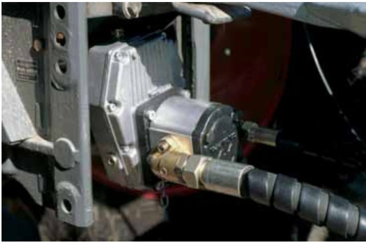
Eigene Ölversorgung mit Zapfwellenaufsteckpumpe
