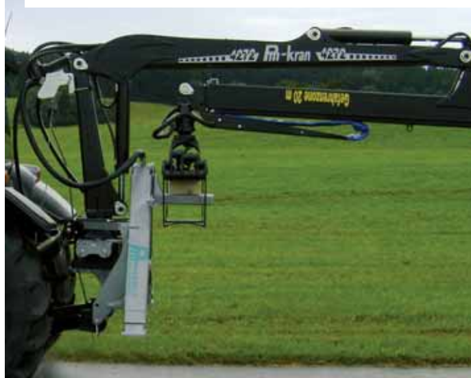
Pm-Ladekran 4272 mit stehendem Zylinder für den Anbau in der Dreipunkt oder Festanbau auf Traktoren.
