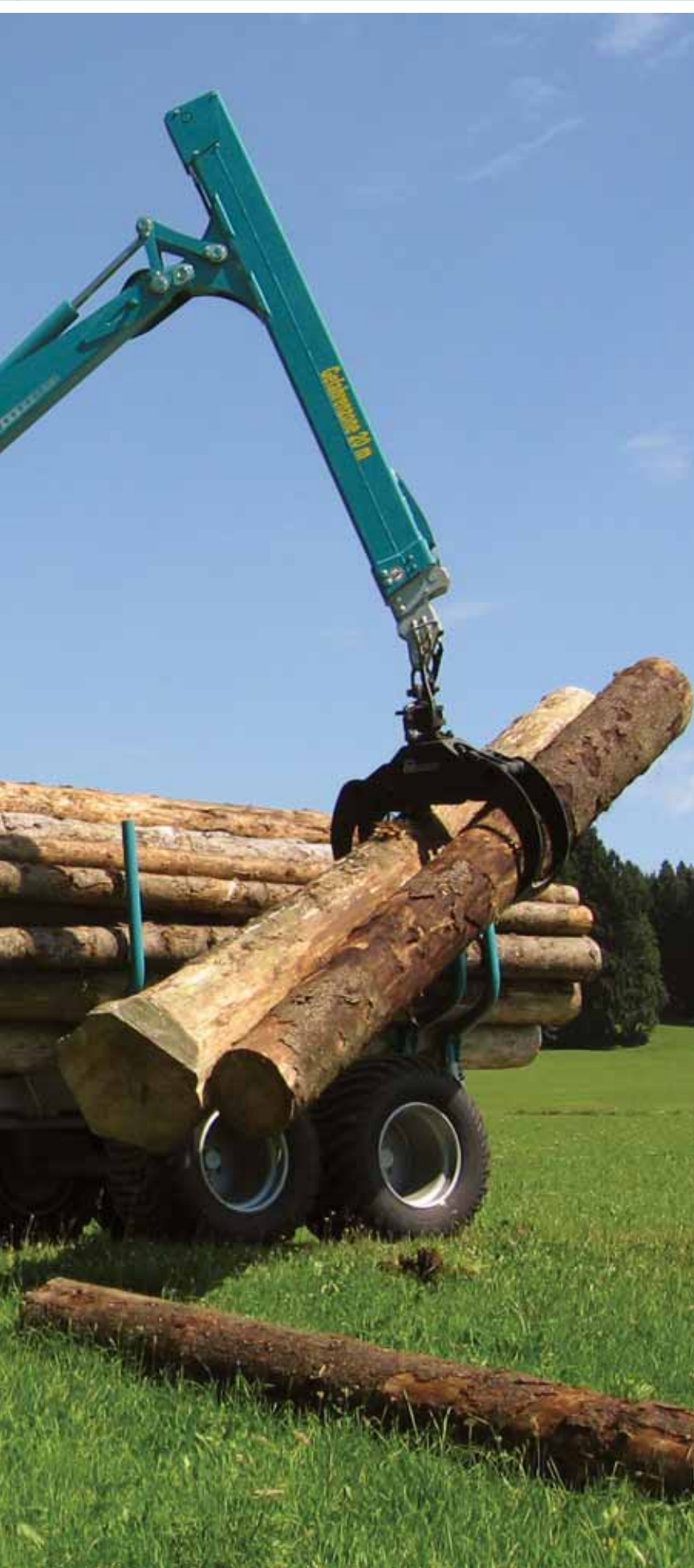
Teleskopstützen machen es möglich eng an das Polder heranzufahren und so die volle Hubkraft des Ladekrans auszunutzen.
