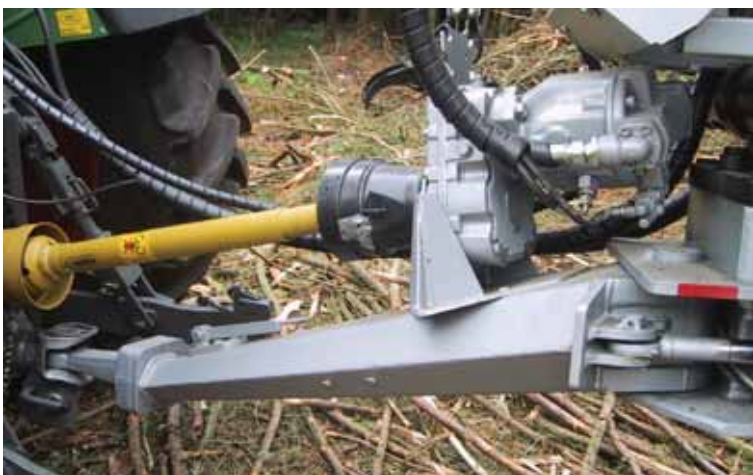
LS-Pumpe fest verbaut auf der Deichsel
