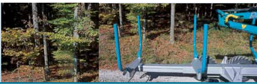
Mit wenigen Handgriffen kann die Ladefläche auf 6 m verlängert werden
