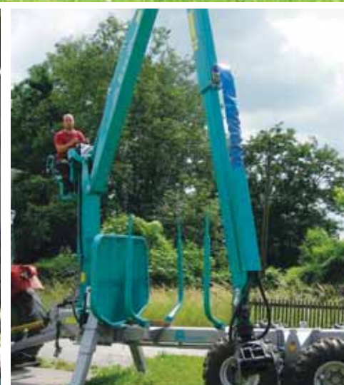
Hydraulisch wird der Hochsitz in Position gebracht
