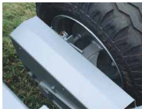
Schutzhaube für Bremsgestänge auf Boogieachse
