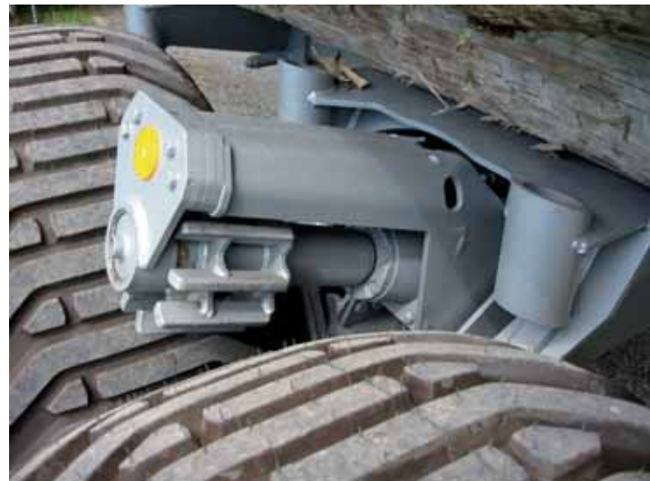
Druckrolle mit Aufnahmekorb, Hydraulikmotor und Bedienungszylinder
