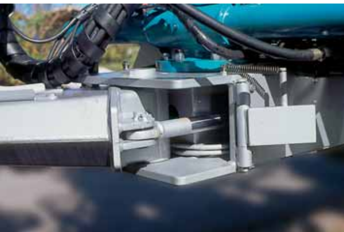
Schwenkbare Deichsel, mechanische Arretierung für Straßenfahrt
