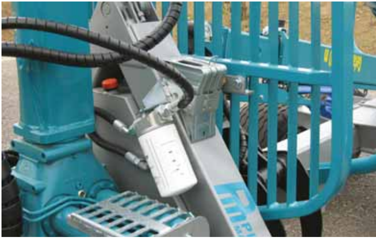
Aufgeräumt und ohne Sichteinschränkung, Ölvorratstank für eigene Ölversorgung
