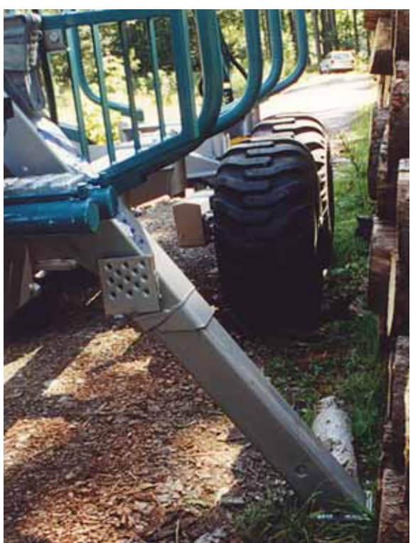
Teleskopstützen machen es möglich eng an das Polder heranzufahren und so die volle Hubkraft des Ladekrans auszunutzen.
