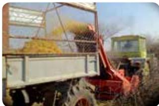
La trémie d'expulsion pour la récolte du matériel est ouvrable et la bande de transport est réglable hydrauliquement.
