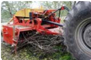
Solution mécanique pour éliminer les bois de taille qui s'accumulent en des hauts andains: broyeur avec dispositif pick-up et grille d'affinage.
