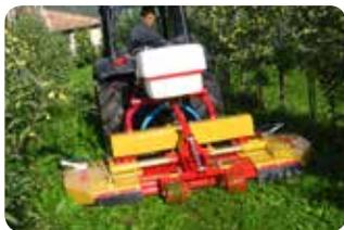
Le profil très bas du broyeur d'herbe à lames rotatives permet de travailler dans les vergers, au dessous de la cime d'arbre, sans en abîmer les fruits. La coupe est précise et l'herbe hachée se distribue uniformément.
