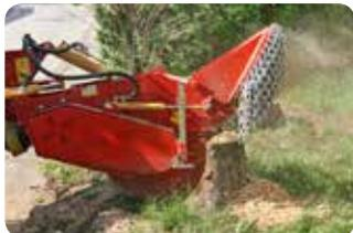
Les fraiseuses de souches SEPPi M. sont des moyens efficaces pour rogner les souches sans limite de diamètre, et selon le modèle, jusqu'à 50 cm de profondeur. Elles fraisent finement le bois pour qu'il se décompose vite, devenant du terreau fin.
