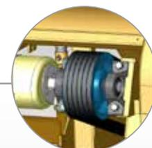
transmission à courroie multi-bande avec tendeur à ressort et joint de sécurité
