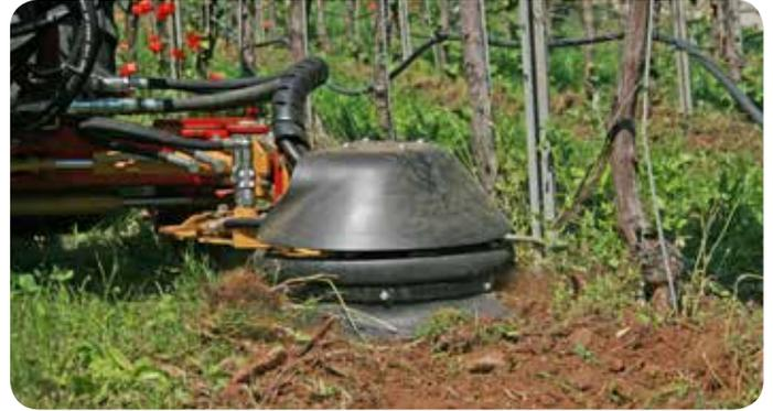
La **roue déracineuse XSA** est un outil de travail pour l'agriculture biologique. Avec un procédé mécanique on coupe les racines des mauvaises herbes en profondeur et ensuite les ramène en surface.
