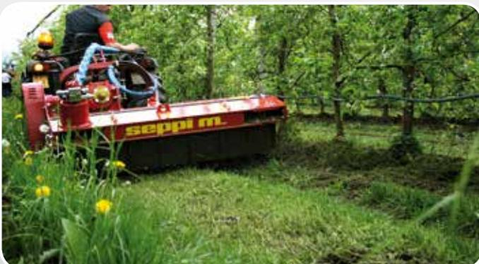
Le **tapis roulant XTR** dépose l'herbe hachée à côté du broyeur et couvre le pied des plantes, empêchant considérablement que l'herbe ne repousse en apportant des substances nutritives au niveau du tronc et des racines.
