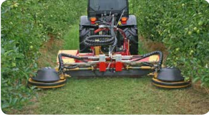
La **roue faucheuse XSC** coupe de l'herbe entre les rangées des vignes et des vergers. En double version, montées sur un broyeur, les roues faucheuses permettent d'adapter la largeur de travail exactement à la largeur de la rangée, en diminuant le nombre de passages nécessaires.
