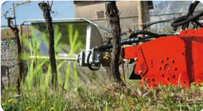
La **brosse de ceps XSP** permet un nettoyage mécanique du tronc et du sol en dessous des branches.
