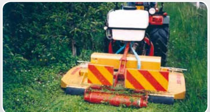
Le **pulvérisateur d'herbicide XID** peut être combiné avec les broyeurs SEPPI M.. Les buses de précision permettent de régler le jet et de déparasiter là où le broyeur n'arrive pas.
