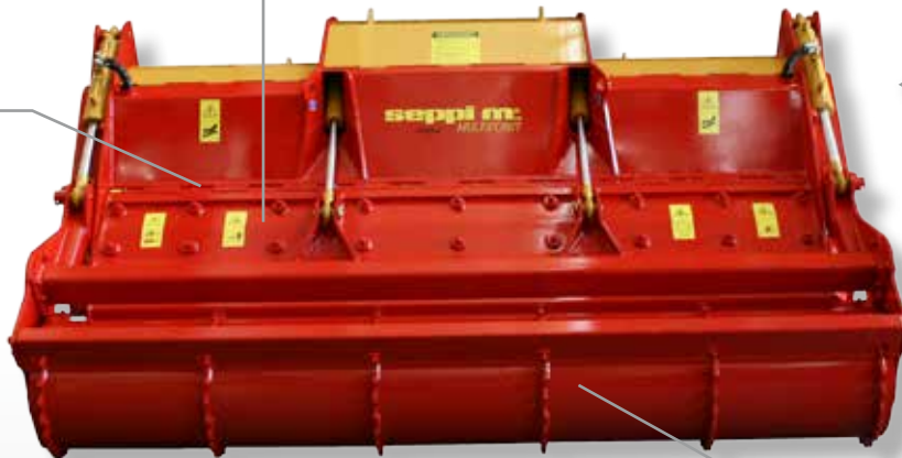
rouleau compacteur du sol baissé et haussé; le rouleau relevé peut être utilisé comme rabatteur de branches
