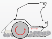
regolabile barra di frantumazione per regolare il grado di sminuzzamento
