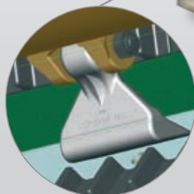
martello SMO e doppia controlama all'interno del telaio
