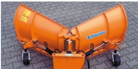
Schaufelform, Verstellzylinder, Stützräder Shovel-shape, adjusting cylinder, support wheels Forme de pelle, vérin de réglage, roue de support
