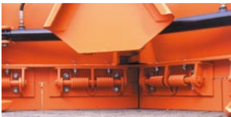
Federklappe mit Kunststoffschürfleiste Spring flap with plastic scraping rib Clapet à ressort et bande racleuse en synthétique
